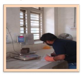
FIGURE 9: DRY WEIGHT OF SAMPLE BRICK
