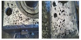
(c) Blow holes on plate 5 and (d) Blow holes on plate 9
