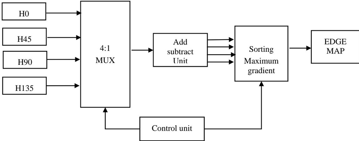
Fig. 3 Edge detection block
