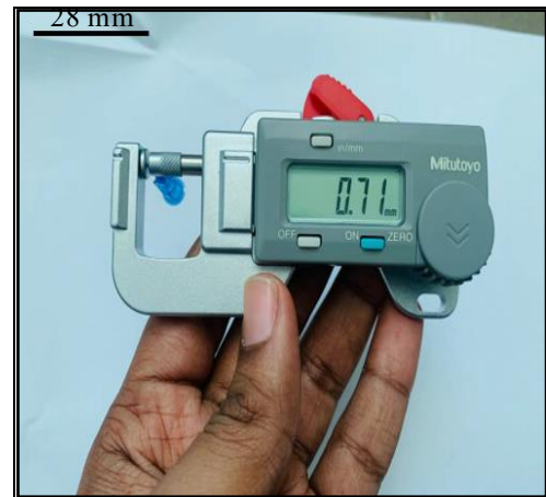
Fig. 3 Quick-mini thickness gage (Mitutoyo PK-0505)
