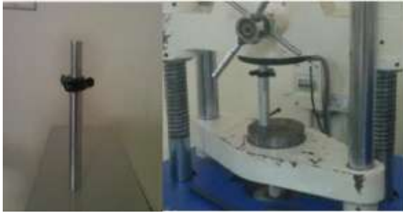
Fig. 28. Slippage test on UTM
