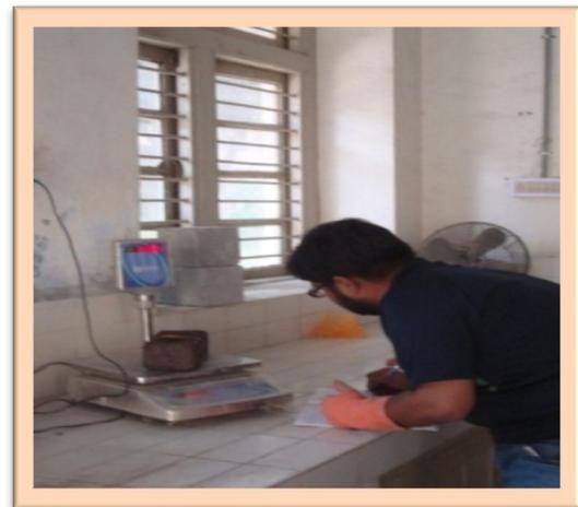
FIGURE 9: DRY WEIGHT OF SAMPLE BRICK
